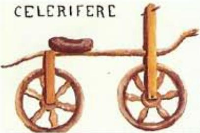
Son inventeur, un ingénieur allemand, le baron DRAIS réalisa en 1817 « un instrument de locomotion à deux roues reliées par une pièce de bois sur laquelle on montait à califourchon et que l'on faisait avancer par l'action alternative des pieds sur le sol ». Perfectionnement notoire : ce véhicule était muni d'une direction à pivot.
